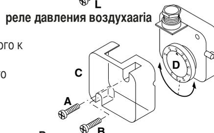
**Н.В.** – Давление в гнезде "E" должно находиться в рабочем диапазоне реле давления. В противном случае ослабить блокировочную гайку винта "F". Регулирование производится постепенным вращением винта "F" по часовой стрелке для уменьшения давления и против часовой стрелки – для его увеличения. Затем затянуть блокировочную гайку.
